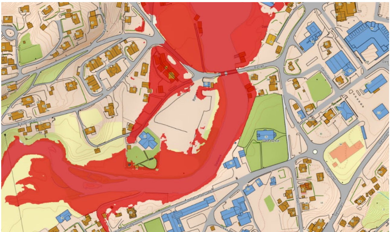
Figur 4-31: Situasjon viser 200-års stormflo med klimapåslag. Fleire bygg på vestleg side av elva vert råka av vasstanden, og vegen langs fjorden står under vatn.
