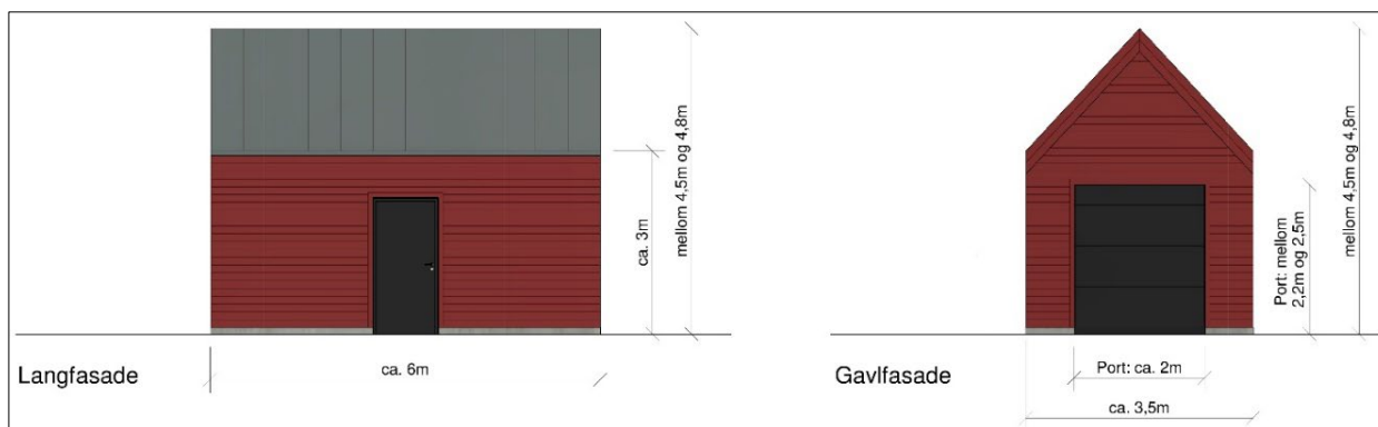
Figur 5-11: Fasadar for teknisk bygg
